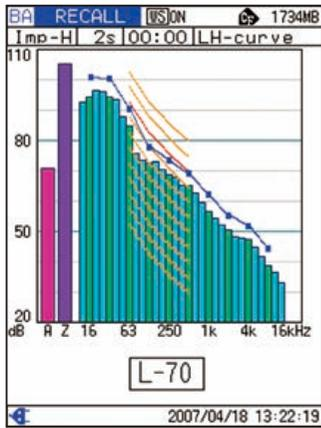
重量床衝撃音遮断性能測定結果
