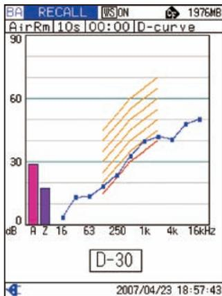
空間空気音遮断性能測定結果
