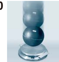
インパクトボールでの衝撃力測定
