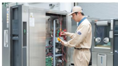
※TCC-151Wは7.5kW以上の冷凍空調器を搭載しています。3か月に1回以上の簡易点検・年に1回以上の定期点検が必要です。簡易点検・定期点検は、エスペックへご依頼ください。→P.14
