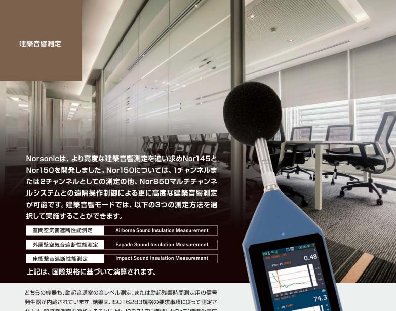
を550の機器も、励起音源室の音レベル測定、または励起残響時間測定用の信号発生器が内蔵されています。結果は、ISO16283規格の要求事項に従って測定されます。暗騒音測定を追加することにより、ISO717に準拠したDnT(標準化音圧レベル差)及びRw(重みつき音響等価損失)の演算が可能なほか、Nor277タッピングマシンの併用によるLn,w(重みつき基準化床衝撃音レベル)の測定・演算も可能です。
